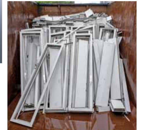
Funktionierender Aluminium-Recyclingkreislauf: Alte Profile werden gesammelt (unten) und aus dem Alu-Schrott entstehen neue Fensterprofile (links: Schüco AWS 90.SI+ Green).
